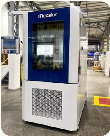
Cámara climática EC / 0,7 / AR-URC
